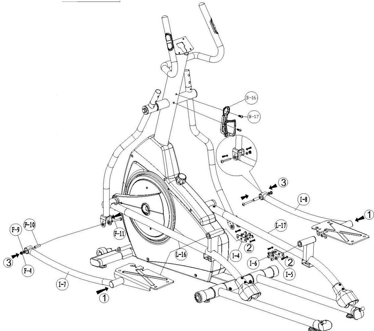
1. Закрепите правую и левую опоры педалей (I-7,I-8) на правой и левой опоре шатуна (L-16,L-17) с помощью оси (I-4), шайбы (I-5), винта (I-6) с каждой стороны.
