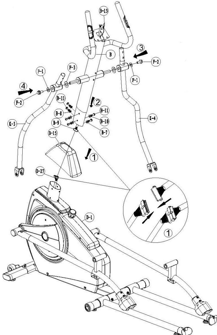
1. Снимите крепежные элементы, установленные на основной раме.
