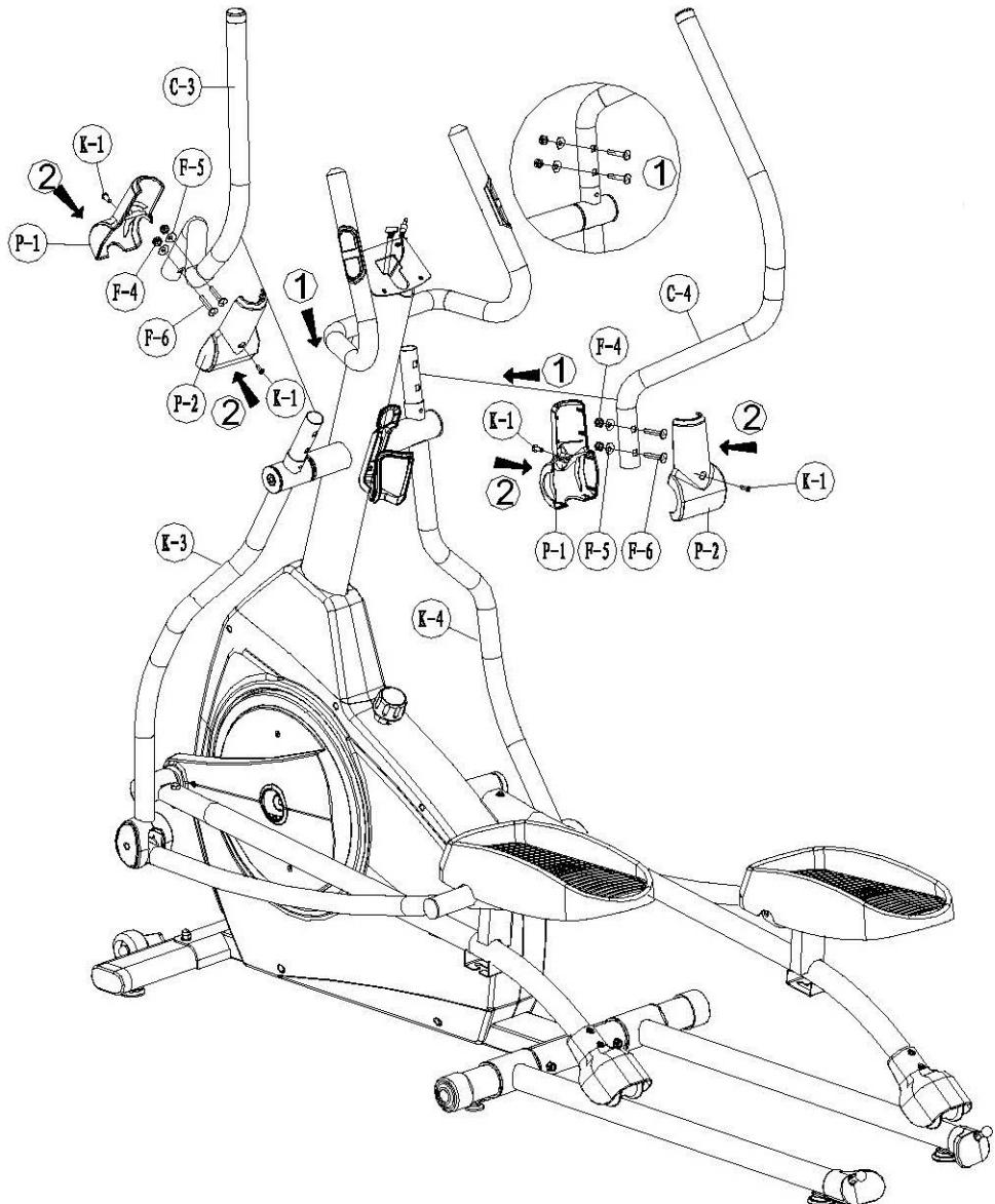
1. Закрепите верхний левый руль (С-3) на нижнем (К-3), используя 2 гайки (F-4), 2 шайбы (F-5) и 2 винта (F-6).
