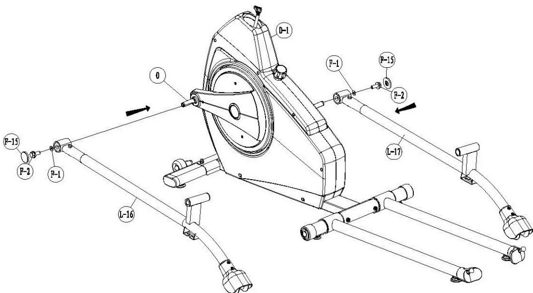
1. Закрепите левую опору шатуна (L-16) на основной раме (D-1), используя 1 шайбу (F-1), 1 винт (F-2) и 1 крышку (F-15).
