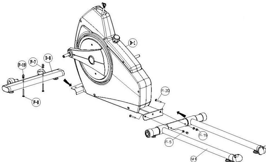
1. Закрепите переднюю опору (F-8) на основной раме, используя болт (F-8), шайбу (F-7) и гайку (F-19).
