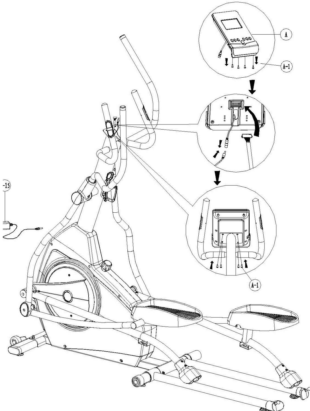
Соедините кабель консоли (В-9) и провод пульсомера (В-13). Затем закрепите консоль (А) на держателе и закрепите винтами (А-1).
